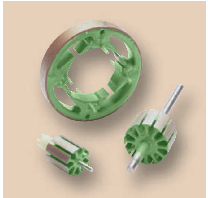
Aplikace práškové pryskyřice Scotchcast 260, která se nanáší především stříkáním nebo namáčením na předeřtý díl
